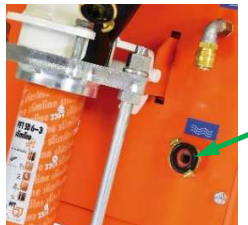
Afb. 115: Vuilvervangzeef in de waterinloop
